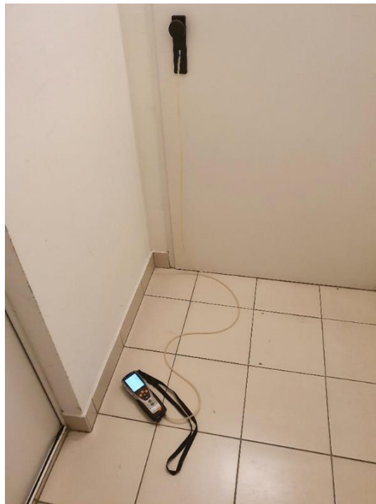
1. számú kép – Differenciálynomás mérése lépcsőház előtéri ajtón keresztül (szerző felvétele)
