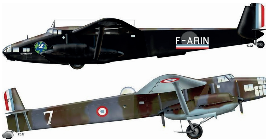
4. ábra Az NC 223.4 (felül) és az NC 223.3 (alul) közötti különbség [9]
