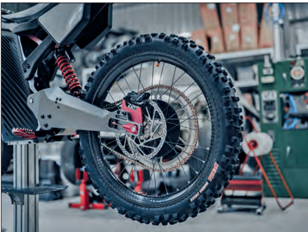
8. ábra. 3D-s nyomtatott titánalkatrészek a hajtásláncon, és szénszálhas hátsókerék az amerikai Graft elektromos endurónál [23]
