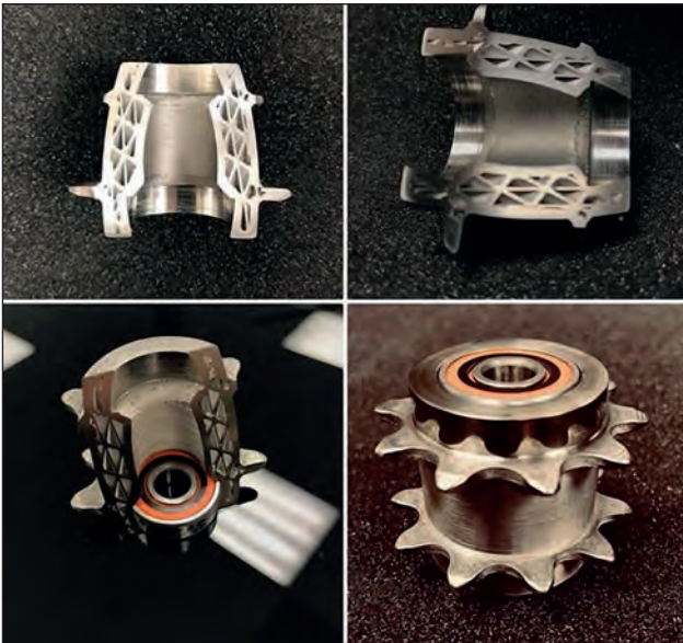
4. ábra. Az ADAM-fémnyomtatási technológia zárt belső cellák létrehozására alkalmas a gépelemen belül, ami csökkenti a tömeget [24]
