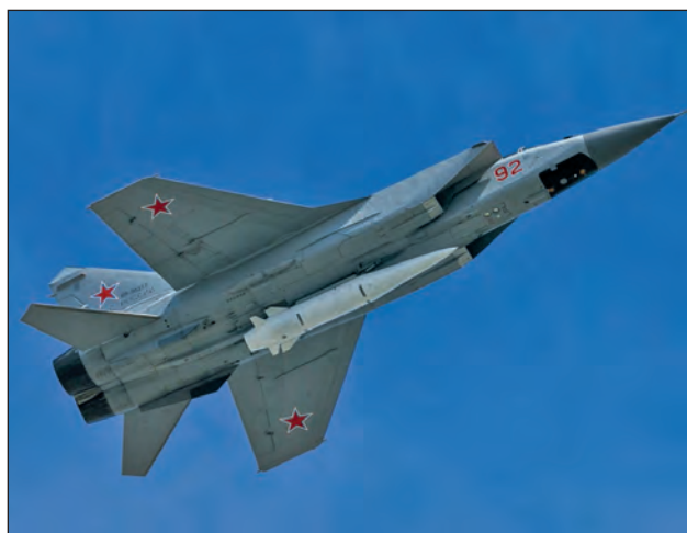
11. ábra. Az Orosz Légi- és Űrerők Mikojan-Gurjevics MiG-31K típusú nehéz elfogó vadászrepülőgépe 9-S-7760 (Kh-47M2) Kindzsál függesztménnyel, a 2018-as moszkvai győzelem napi parádén [34]
