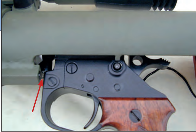
36. ábra. A válltámaszcsőben lévő rögzítőkúp és a zárfej-markolat szerelvény kapcsolata
