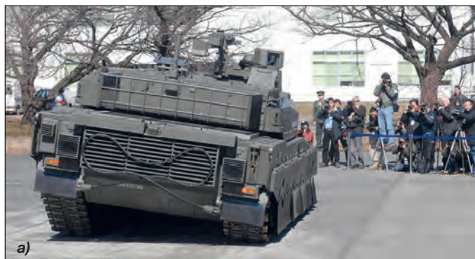
14. ábra. A Type10 kísérleti példánya a TK-X oldaldőlésben, szemléltetve a hidropneumatikus felfüggesztést a). A futómű védelmét köténypáncél biztosítja b) [29]
