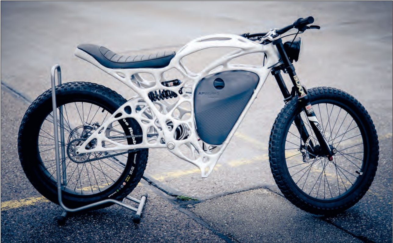
7. ábra. Az Airbus 3D-s nyomtatott fém motorkerékpár váza, amely mindössze 6 kg tömegű [21]
