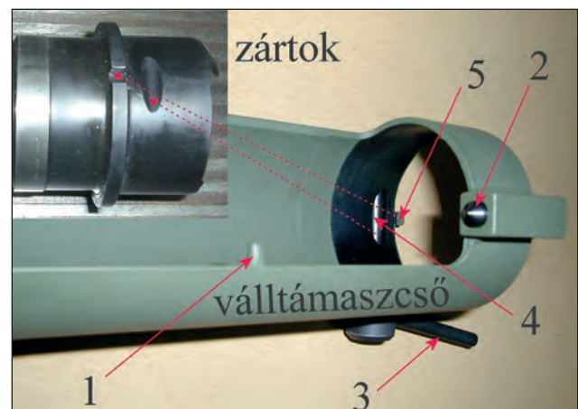
35. ábra. A váltámaszcso reteszeltői: 1. elsütésbiztosító vezérlőszemölcs, 2. zárfej-markolat szerelvény reteszeltő kúp, 3. váltámaszcso reteszeltő kar, 4. a váltámaszcso reteszeltő rúd alakos kötése, 5. a váltámaszcso pozícionáló retesz; a szaggatott nyilak az egyes reteszeltő elemek kapcsolódási helyére mutatnak a zártokon
