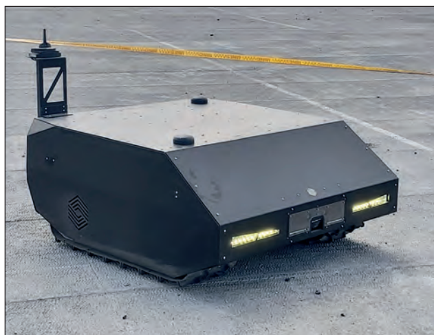
2. ábra. Az elsősorban szilárd útburkolaton való mozgásra optimalizált ARX GEREON RCS UGV egy bemutató alkalmával (Fotó: Ocskay István)
