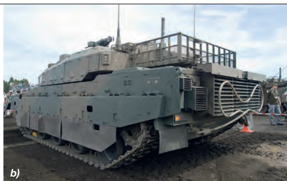
14. ábra. A Type10 kísérleti példánya a TK-X oldaldőlésben, szemléltetve a hidropneumatikus felfüggesztést a). A futómű védelmét köténypáncél biztosítja b) [29]
