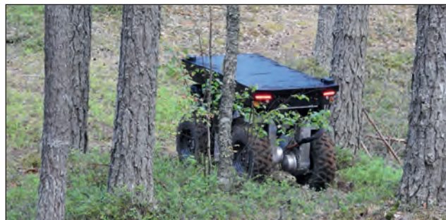
4. ábra. A dőlést és lejtést kiküszöbölő futóművel szerelt ARTUS PTAone erdei portyáján (Fotó: Ocskay István)
