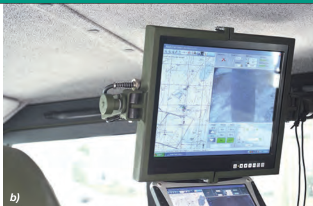
4. ábra. Irányító konzol a), kombinált kijelző, amely egyszerre jeleníti meg a digitális térképet, valamint a kameraképet b) (Forrás: MH Bornemissza Gergely 2. Felderítőezred, HM Zrínyi Nkft. / Rácz Tünde)
