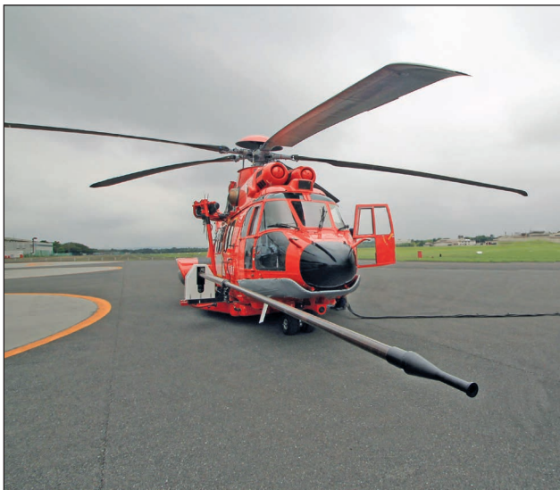
6. ábra. Egy Simplex 316 SkyCannonnal, azaz rotorkörön túlnyúló merev sugárcsővel szerelve [14]
