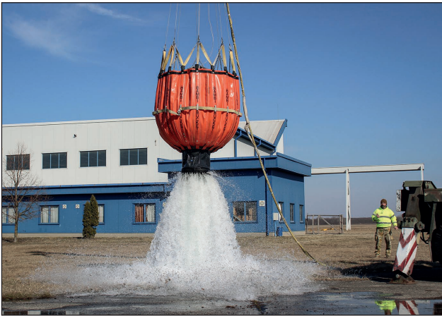
1. ábra. A SEI Bambi Bucket BB5566 típusú légi tűzoltó eszköz leeresztő szelepének működéspróbája az MH 47. bázisrepülőtéren, Pápán (Fotó: MH 47. bá. reptér archív)
