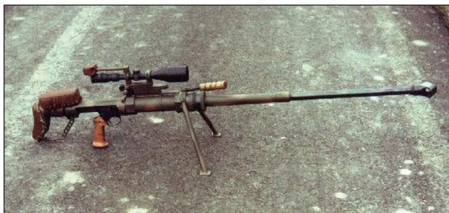
20. ábra. Az átépített Gepárd III. kísérleti mintapéldánya a szemlencsetubus-távtartóval, az új villalábakkal, a lággyűrűre felszerelt hordfogantyúval és állítható pofadékkal
