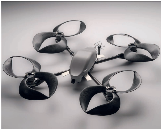
9. ábra. Célszerűen 3D nyomtatással előállítható fejlett toroid geometriájú UAV légcsavar [51]
