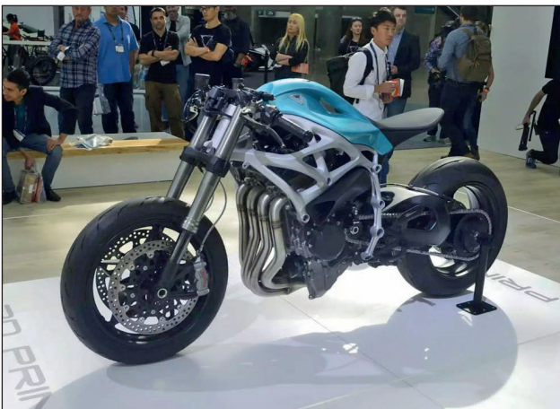
19. ábra. Divergent 3D Dagger motorkerékpár szénszál-erősítésű 3D-s nyomtatott vázzal [49]
