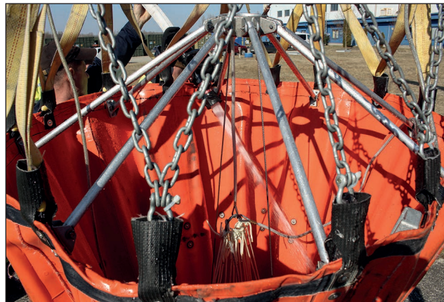
2. ábra. A Bambi Bucket belső szerkezete (Fotó: MH 47. bá. reptér archív)
