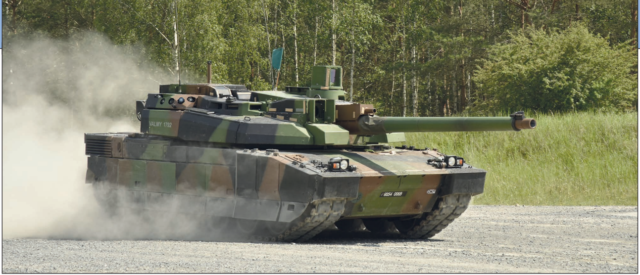
6. ábra. A francia Leclerc harckocsi mozgékonyágát egy Hyperbar eljárással üzemelő dízel erőforrás biztosítja. A Leclerc harckocsi Jacques Philippe Leclerc francia tábornok után kapta a nevét [15]
