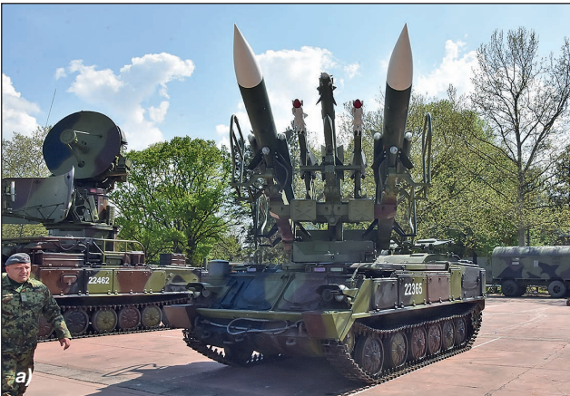
16. ábra. A szerb légvédelem 9K12ML (Kvadrat) rendszerének indítóállványa szemből a), és hátulról b). A modernizált Kub SzPU (TELAR) indítóállvány esetében a középső rakéta helyére három darab R-60 vagy R-73 típusú infravörös, hőkövető rakétaindítót szereltek, ezzel csökkentve a veszélyt, hogy az egycsatornás légvédelmi rendszer másik támadási irányból védtelen maradjon. A hőkövető rakétákhoz nem szükséges a komplexum célravezető lokátorának használata (Fotók: Kelecsényi István)
