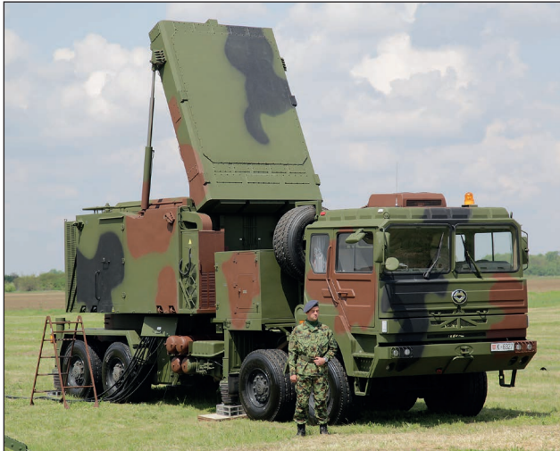
18. ábra. A HQ-22/FK-3 komplexumhoz tartozó H-200 típusú célkövető lokátor (Fotó: Kelecsényi István)
