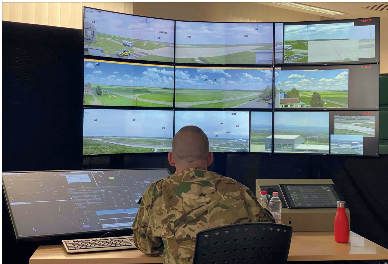
5. ábra. A PJ05 keretében, teszthelyszínen működő távoli irányító munkaállomás (rTWR CWP) (A szerző felvétele)
