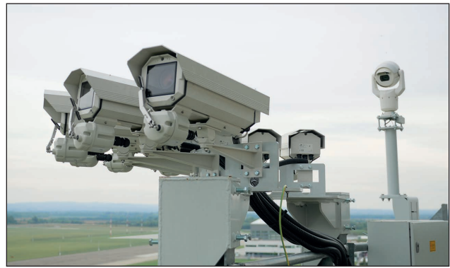
3. ábra. Egy rTWR-kamera-konfiguráció a pápai MH 47. Bázisrepülőtéren (A szerző felvétele)
