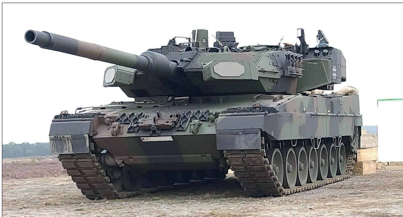
14. ábra. A német Leopard 2A7V harckocsi kísérleti Trophy aktív védelmi rendszerrel felszerelve [23]
