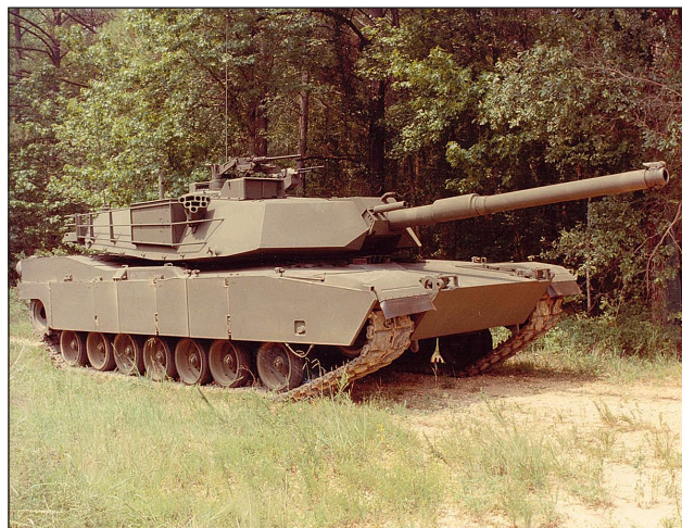
11. ábra. Egy felségjelzés nélküli, még gyári tesztelésen lévő M1IP (Improved Performance) növelt képességű amerikai harckocsi [18]
