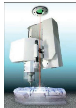
21. ábra. A Matsuura Lumex hibrid gép felépítése. Lézersugár végzi a por olvasztását, utána a marógép része simítja a nyomtatott felületet [26]
