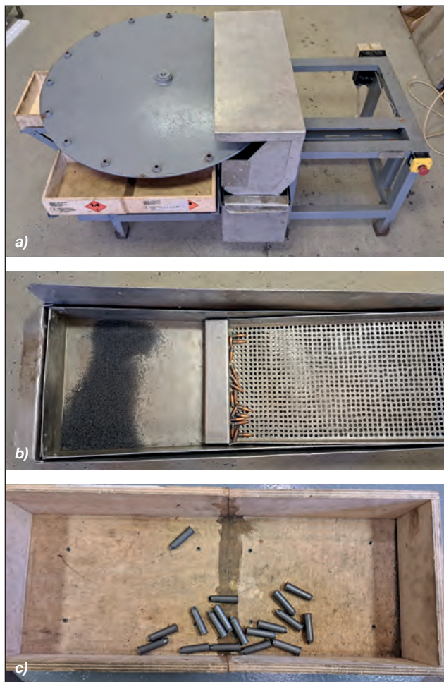
4. ábra. 001-LKB-BPPV típusú lövészlőszer lövedékkitörő berendezés a). Lőporfelfogó tálca és kitört lövedékek b). LPSZ-hüvelyek kitörés után, hatástalanításuk előtt c) (A szerző felvételei)
