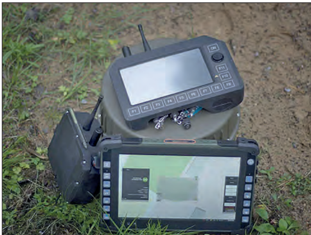
3. ábra. Sentry típusú harckocsi elleni akna a rendszerhez tartozó távvezérlő és kommunikációs eszközökkel [18]
