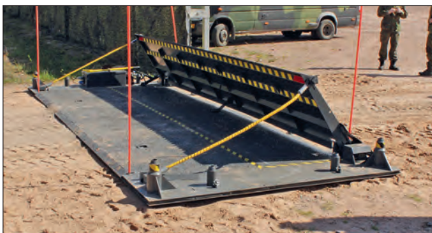
17. ábra. Balpro hidraulikus kapuelem védelmi üzemmódban [17]
