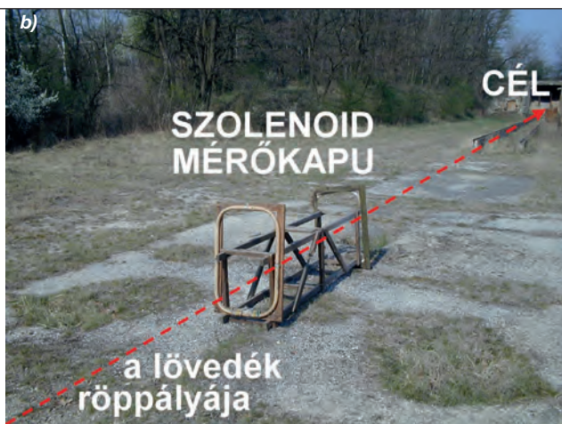
7. ábra. A sebességmérő indukciós keretek elhelyezése a mérővonalon a), a szoleonid mérőkapu nézeti képe a 100 m-es mérővonalon b)
