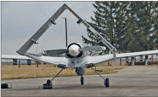
9. ábra. A török Bayraktar TB2-es felfegyverzett drón építésénél a könnyűrepülőgép-építésben széles körben elterjedt technológiákat és fődarabokat alkalmazták, amely alacsony szinten tartotta a költségeket és lehetővé tette a tömeggyártást [35]
