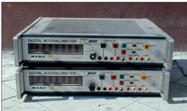
6. ábra. A Műszeripari Kutató Intézet időmérő műszerei a két indukciós kerethez
