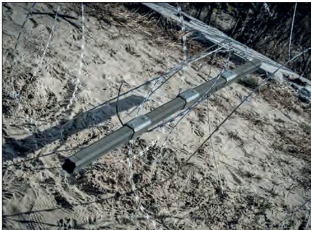
7. ábra. Bangalore Blade átjárónyitó nyújtott töltet több egysége összekapcsolható a csatlakoztató elemek segítségével [18]
