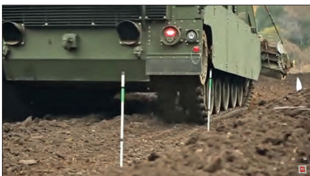
15. ábra. Az aknamentes átjáró szélének jelölése [10]
