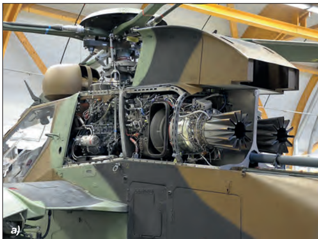
28. ábra. Az MTR390 típusú hajtómű az Airbus Helicopters Tiger erőforrása és metszeti képe [31]
