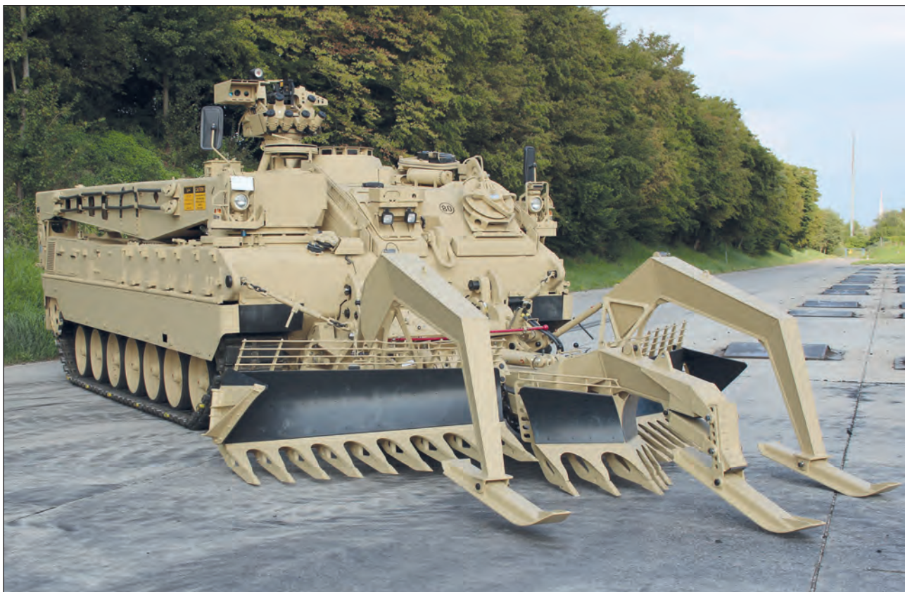
13. ábra. WiSENT 2 MB gépváltozat aknakifordítóval és darugémmel (Forrás: FFG)
