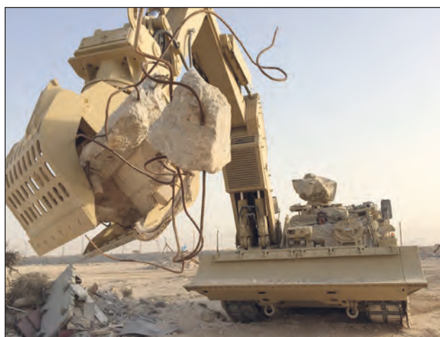
10. ábra. Bontási törmelék mozgatása Wisent 2 AEV segítségével (Forrás: FFG)
