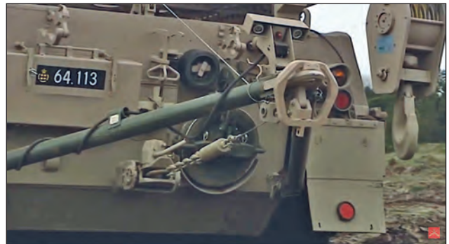
7. ábra. A speciális vonórúd az éjjel/nappali kamerarendszerrel [7]
