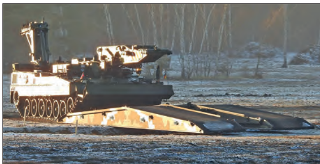
12. ábra. A KMW vállalat Leguan 2 AVLB távirányított hídvető harcokocsija, az általa korábban lefektetett 14 méteres hídelemre hajt fel (Fotó: Ocskay István)
