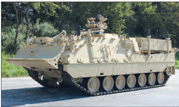
6. ábra. A WiSENT 2 ARV változatának eleje a tolólappal (Forrás: FFG)
