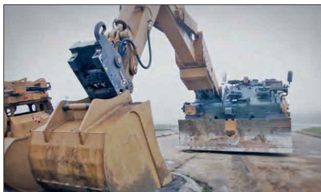
9. ábra. Kotrókanál cseréje a hidraulikus gyorscsatlakozóval [8]
