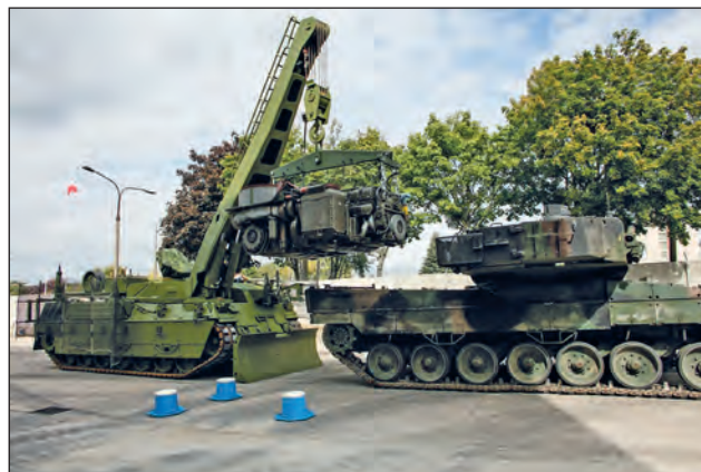
2. ábra. Egy meghajtóegység cseréje [3]
