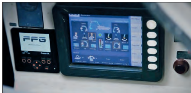
8. ábra. A hidraulika-rendszer érintőképernyős kezelőpanelja [7]
