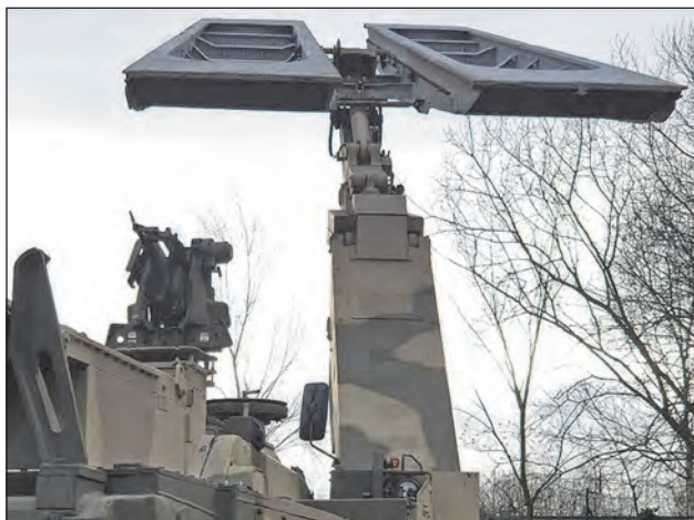
11. ábra. A nyompályás hídelem felemelése szállítási helyzetből [6]
