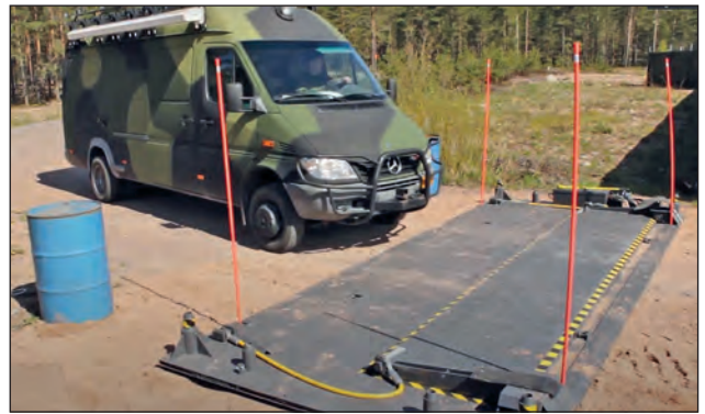
18. ábra. A Balpro hidraulikus kapuelem, zárt állapotban biztosítja a normál gumikerekes járművek áthaladását [17]
