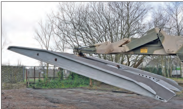
12. ábra. A hídelem mozgatása az előrenyújtott kotrókarral [9]
