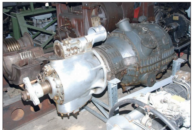
7. ábra. Jendrassik tengelyteljesítményt szolgáltató CS-1 gázturbinája. A típusjelzés a „Csónakmotor” elnevezésre utal, a tárgy a Magyar Műszaki és Közlekedési Múzeum Műszaki Tanulmánytárában látható (Forrás: MMKM)
