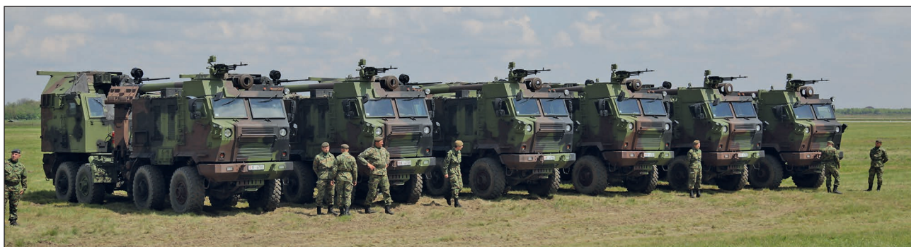
11. ábra. A szerb gyártású M84 NORA B-52K önjáró tarackágyút 8x8-as FAP 2832 típusú alvázra építették (Fotó: Gzásó Krisztián Árpád)
