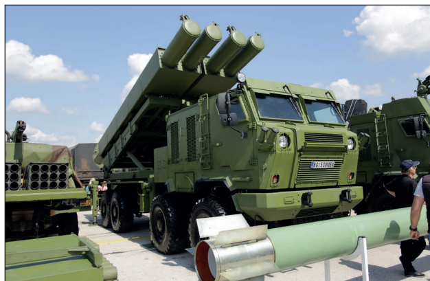
14. ábra. A szerb rakétatüzérség saját gyártású komplexumokon alapul. A FAP–2832 alvázra épített Sumadija önjáró rakétatüzérségi rendszer 2x2 Jerina–1 típusú rakétái 285 km, a kisebbik, Jerina–2 pedig 70 km hatótávolságú (Fotó: Gazsó Krisztián Árpád)
