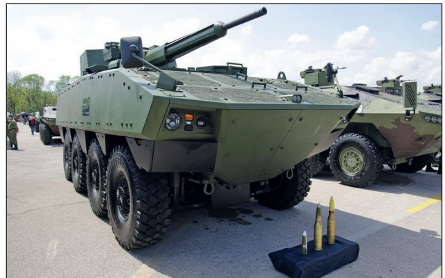
6. ábra. A szerb gyártású Lazar típusú gyalogsági harcjármű 57 mm-es géppágyúval felszerelt változata (Fotó: Gászó Krisztián Árpád)
