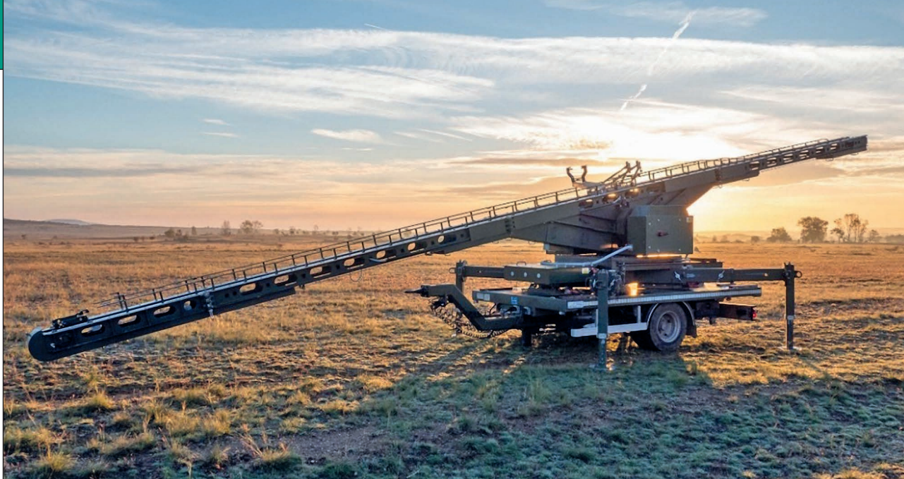
43. ábra. A Protar indításához használt katapult (Fotó: Nagy Attila)
