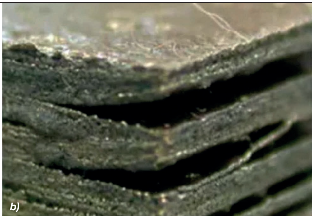
18. ábra. Nem megfelelő nyomtatási paraméterbeállításokat alkalmazva, porágyas eljárásnál a nagy belső feszültségek okozta stressz hatására az alkatrészek megrepedtek a), illetve delamináció (rétegenkénti szétválás) keletkezhet b) [16]
