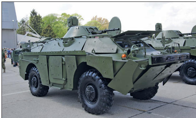
4. ábra. Orosz relációból származó szerb BRDM-2MSz kerekes felderítő harcjárművek, amelyeket – az alapváltozat- hoz képest – kiegészítő páncélatzattal és modernizált optikai eszközökkel szereltek fel (Fotó: Kelecsényi István)
