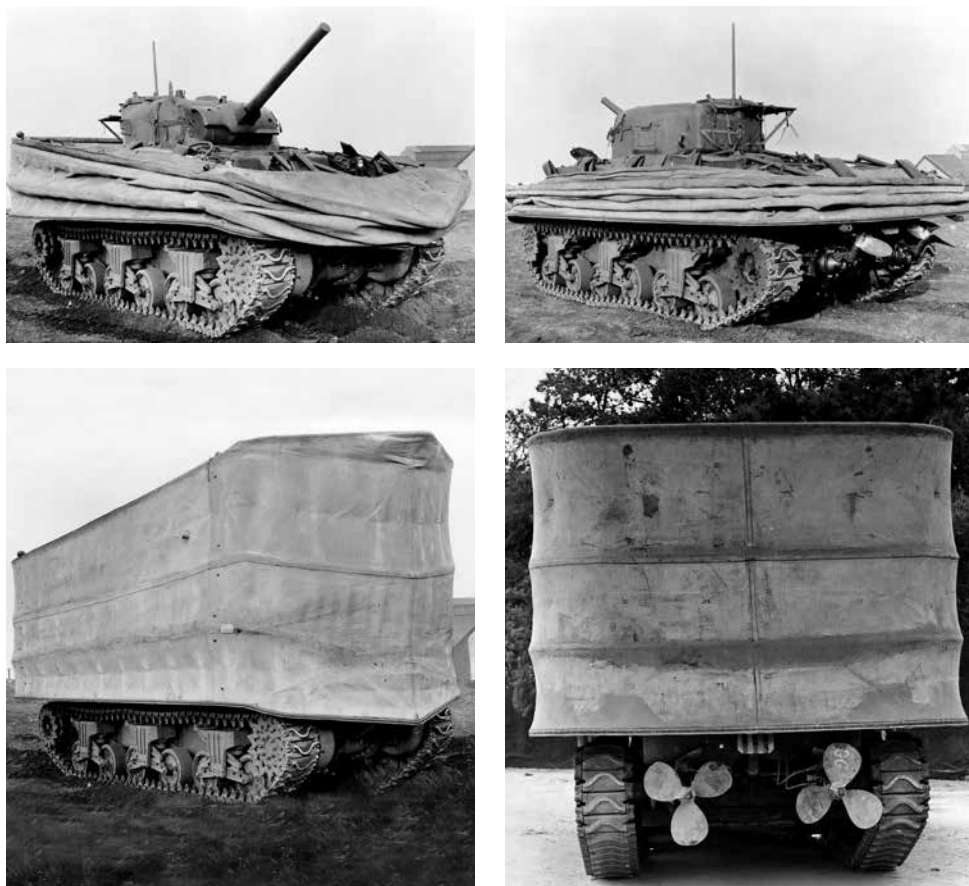
2. kép: A Sherman Duplex Drive leeresztett és felhúzott ponyvával, elől- és hátulnézetből (IWM, MH 3660, MH 3661, MH 3662, MH 2214)
