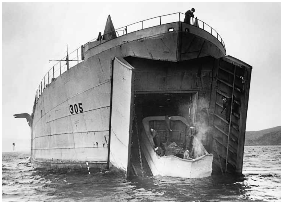
4. kép: Egy Valentine DD indítása egy LST(2)-es partraszálló hajóról (Bovington). A magasabb Sherman DD már nem fért át a csapóajtón
