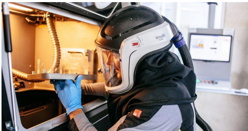
5. számú ábra. A fémporok biztonságos kezeléséhez védőfelszerelés szükséges [8]
