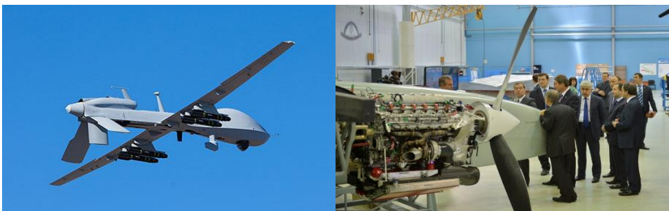
7. számú ábra. Balra: az MQ1 Predator C Gray Eagle, erőforrása Mercedes-alapú Thielert turbódízelmotor. Jobbra: Orosz Altius UAV Audi-alapú V-12 henger-elrendezésű RED-03 típusjelzésű dízelmotorja 17
