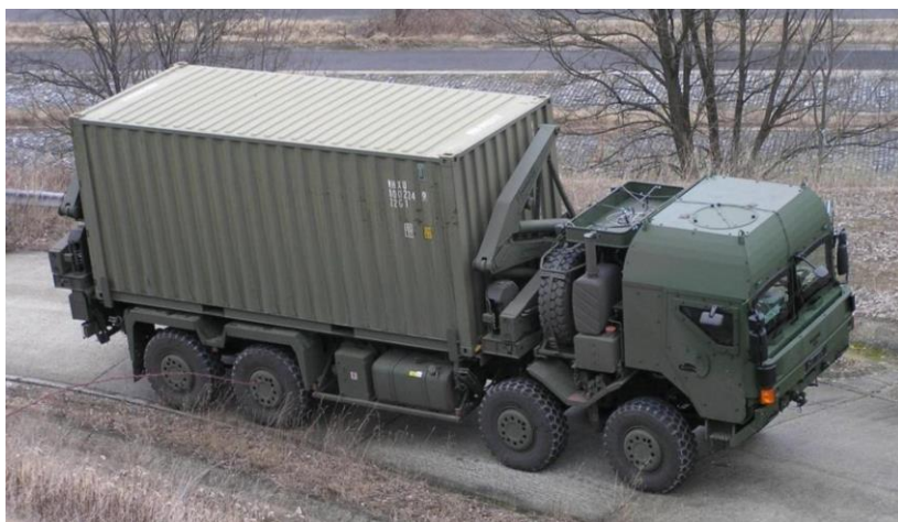
4. számú ábra. A MAN HX32 szintén egy 20 lábás konténerrel szállít, de azt a Hammer 190 HB típusú oldalrakodó segítségével önállóan képes le- és felrakodni [12]
