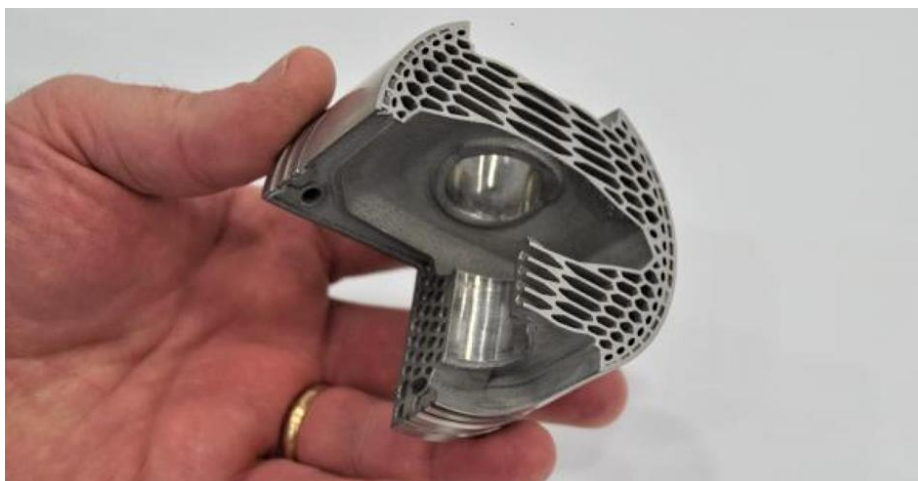
10. számú ábra. Fém 3D nyomtatott dugattyú metszete. A könnyített szerkezet mintegy 25%-kal csökkenti a szerkezeti elem tömegét 29
