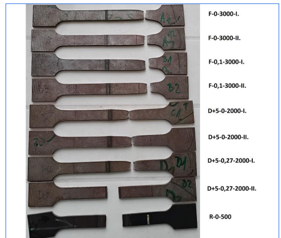
6. ábra. Szakítóvizsgálati próbatestek
