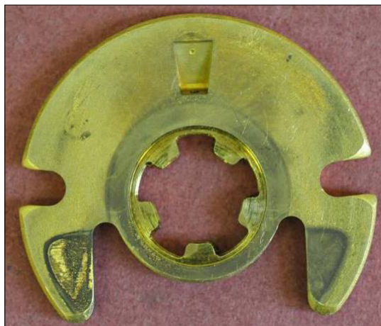
10. ábra. A támcsapágyon kialakult kopási nyomok
