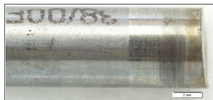
6. ábra. Kopási nyomok a tengelyen
