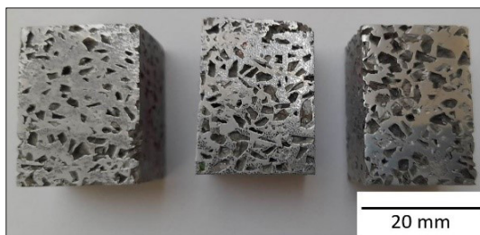
2. ábra. A kimunkált próbatestekről készült kép (balról jobbra Al 2 O 3 erősítésű, nyílt cellás fémhab, SiC részecskével erősített, nyílt cellás fémhab, erősítés nélküli, nyílt cellás fémhab)
