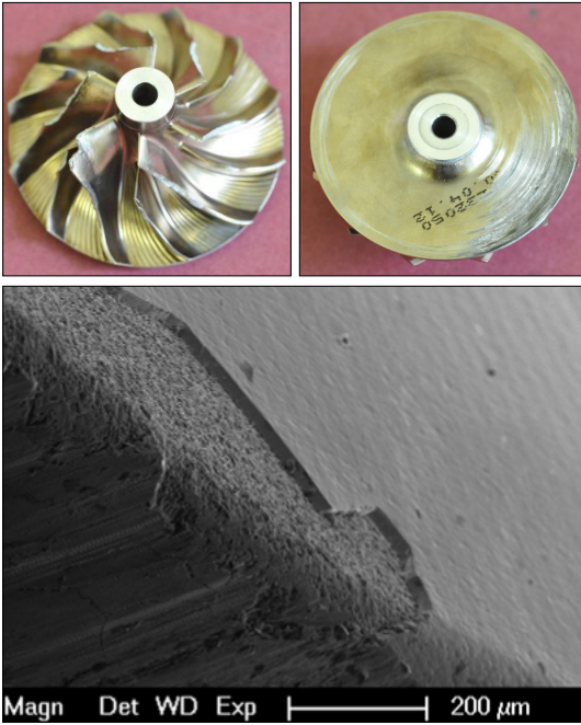
12. ábra. Kopási nyomok a sűrítőkeréken
