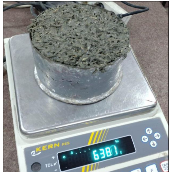
2. ábra. A sűrűség meghatározása
