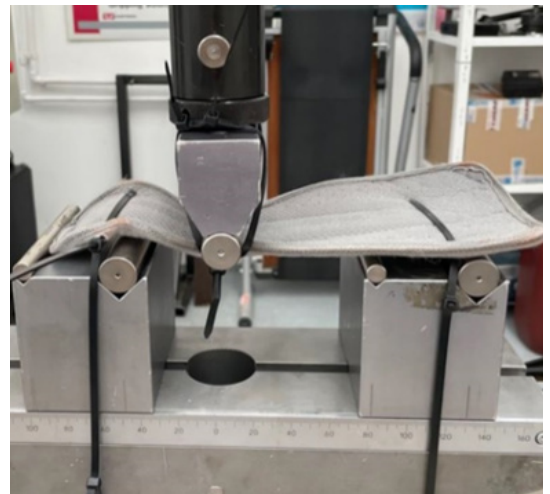
4. ábra. Az ortézis a fásztólvizsgálathoz kialakított készülékben
