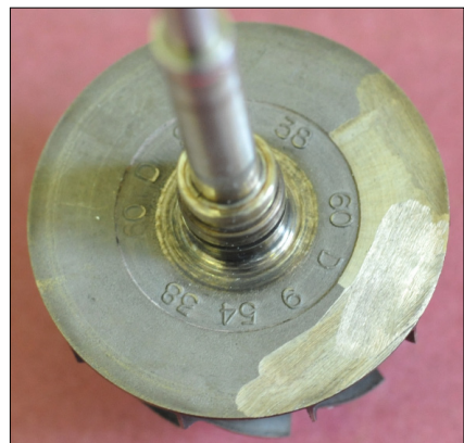
5. ábra. Kopási nyomok a turbinán
