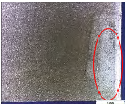
11. ábra. Karcolt (balra) és drótképezett 1.4362 acél próbatetek felülete két hónap után
