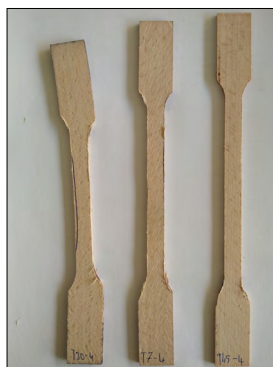
9. ábra. Hosszan fixált, röviden fixált és kezeletlen minták, húzóvizsgálathoz kialakított profillal
