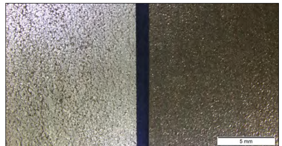
10. ábra. Karcolt (balra) és drótkefézett 1.4362 acél próbatestek felülete két hét után
