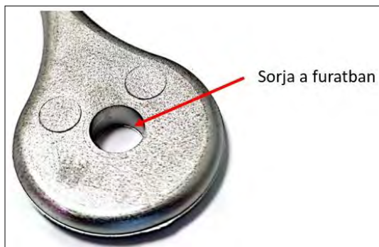
4. ábra. A próbatest furatának sorjásodása
