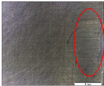
9. ábra. Karcolt (felső) és drótkefézett 1.4462 acél próbatestek felülete két hónap után
