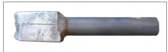
2. ábra. Egylépéses gyártással acélcsőbe töltött szintaktikus fémhab, lehűlés után
