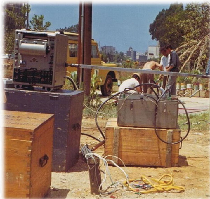
Szlabóczky Pál: Mérnökgeológiai karotázs – Ipari kutatási példatár, Miskolc, 2022 Hordozható kisméretű karotázsszerberendezés
