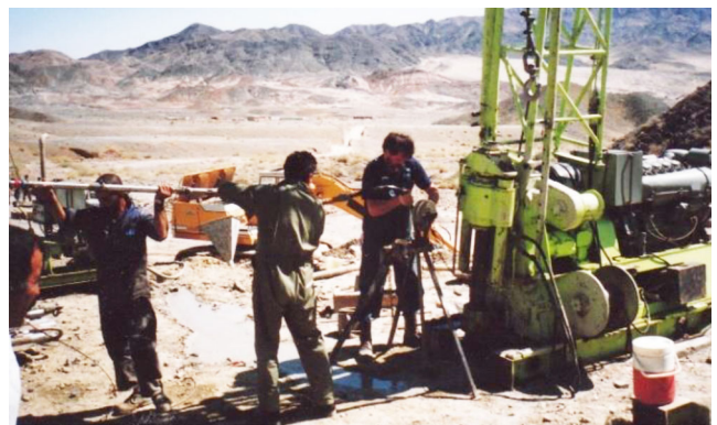
9. ábra. Az akusztikus szonda beengedése a fúrársba
