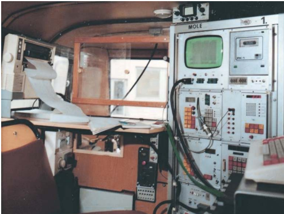
23. ábra. Klasszikus műszerkabinbelső, falra szerelt Epson FX-850 regisztrálóval és MOLE műszerrel
