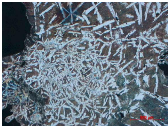
6. ábra: A 2. mintában látható cementit-perlites, finomszerkezetű globulit.
