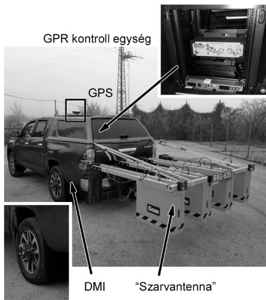
2. ábra: A talajradar főbb elemei (forrás: RODEN Mérnöki Iroda).
