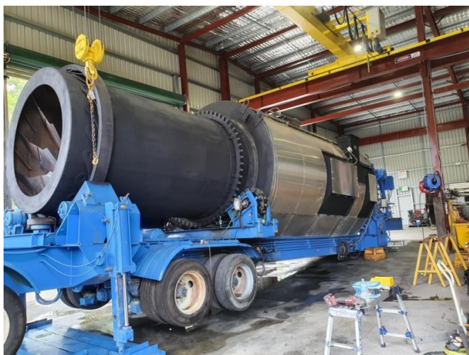
11. ábra: Mobil dupladobos rendszerű aszfaltkeverő gép szárító és keverődobja.
