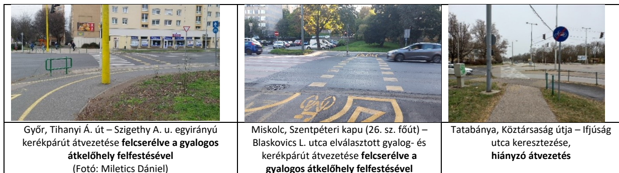
13. ábra. Jelzőlámpás szabályozású kijelölt gyalogos-átkelőhelyekkel közös átvezetések felcserélve, illetve az átvezetés hiánya.
