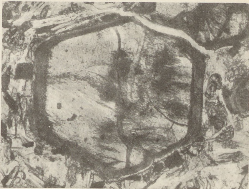
1. Иддингситизированный оливин, внутри с волокнами. Параллельный николь. Увеличение: 190-кратное.
