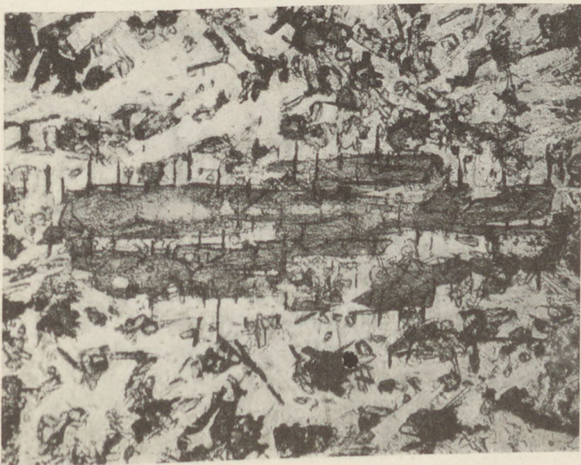
4. Обратстание ориентированных листовых магнетитов на иддингситовых оливинах. Параллельный николю. Увеличение: 120-кратное.
