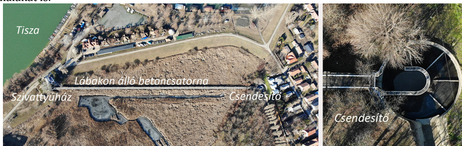
1. ábra. A Tiszafüredi öntöző főcsatorna kezdeti szakasza és annak csendesítőmedencéje
