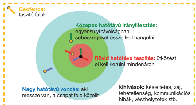
1. ábra. Összehangolt csoportos mozgás alapvető párkölcsonhatásai (taszítás, sebesség-illesztés, vonzás) és környezeti kölcsönhatásai (fal, objektumok satöbbi taszítása)
