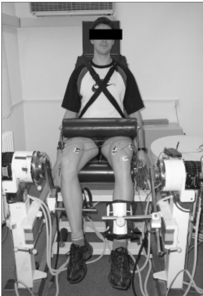
3. ábra/Figure. A vizsgált személy elhelyezkedése a Multicont II izomvizsgáló berendezésen. [The position of the subject on the Multicont II dynamometer.]
