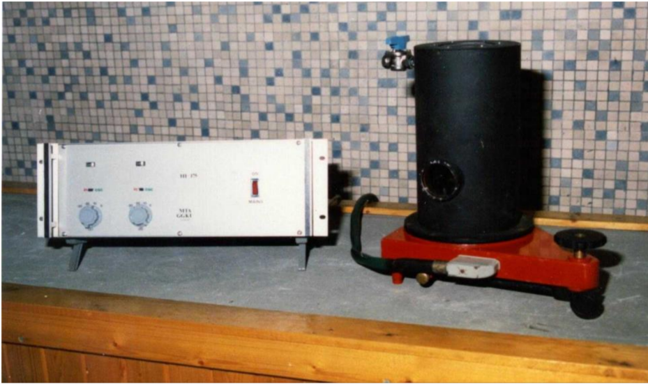
14. ábra. Kapacitív mérőátalakításos horizontális inga.
