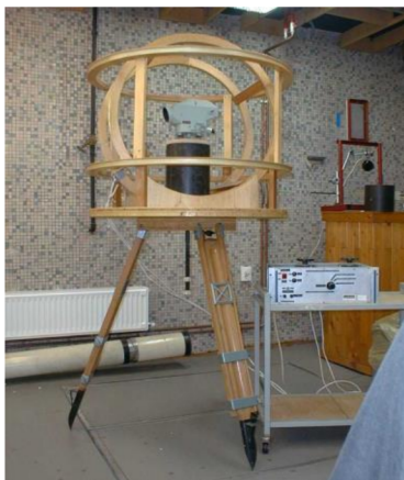
4. ábra. Kompenzátoros szintezőlécz vizsgálata mágneses térben.
