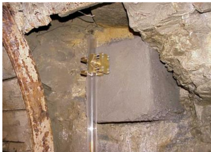
17. ábra. A 3D extenzométeres állomás (Bakonya) vertikális extenzométerének rögzítése a kőzethez.
