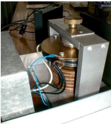
21. ábra. A mikrobarográf belseje az érzékelővel.
