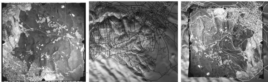
6. ábra. Ortofotó készítés lépései: 1. légifénykép tájékozása, 2. digitális térkép és terepmodell, 3. ortorektifikáció.
