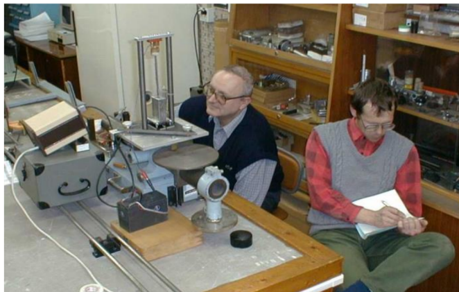
23. ábra. CCD érzékelős dőlésmérő pontosságvizsgálata.
