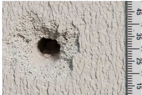
20–21. számú fényképek Bemeneti nyílás (bal) és kimeneti nyílás(jobb) Ytong téglán
