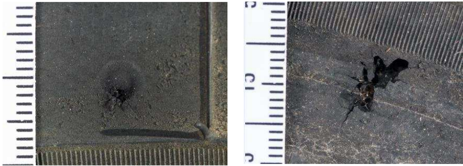
26–27. számú fényképek Bemeneti nyílás (bal) és kimeneti nyílás (jobb) gumiabroncson
