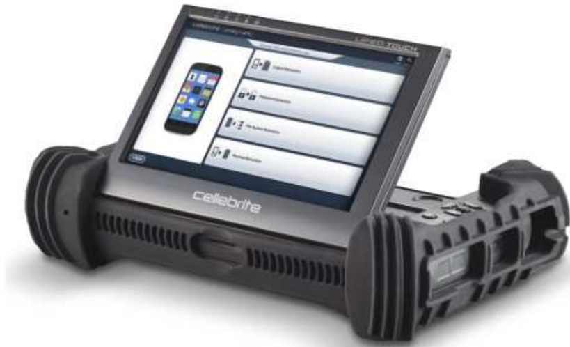
3. számú ábra UFED Touch készülék - mobiltelefonok adattartalmának mentésére használt adatmentő készülék
