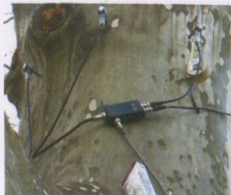
6. ábra. Hangterjedés sebességének mérésével végzett törzsvizsgálat purhabbal kezelt odú alatt
