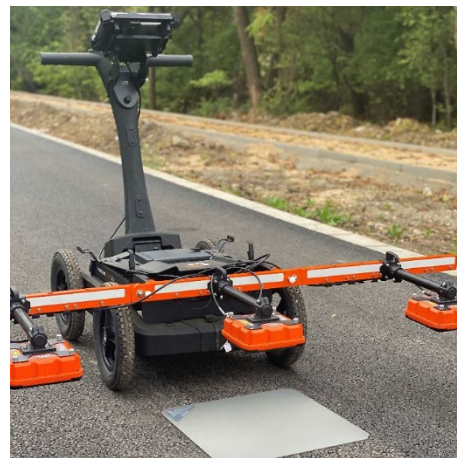
3. ábra. A RODEN Mérnök Iroda PaveScan RDM 2.0 (második generációs) roncsolásmentes aszfaltsűrűség-értékelő mérőberendezése a levegő (bal) és a fémlemez kalibráció (jobb) közben.
