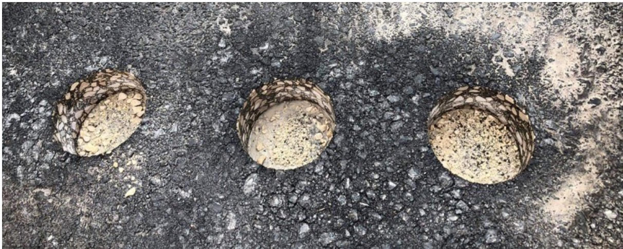
6. ábra. A fúrt magminták elhelyezkedése az alaprétegen.
