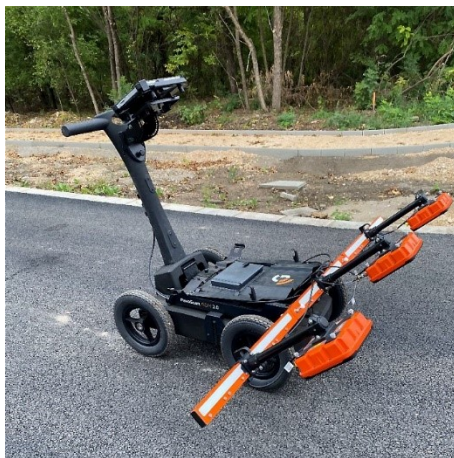
3. ábra. A RODEN Mérnök Iroda PaveScan RDM 2.0 (második generációs) roncsolásmentes aszfaltsűrűség-értékelő mérőberendezése a levegő (bal) és a fémlemez kalibráció (jobb) közben.
