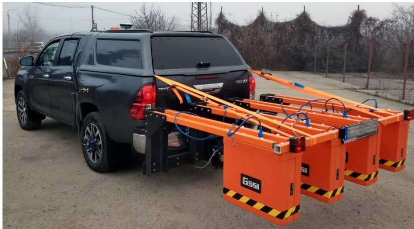
2. ábra. A RODEN Mérnök Iroda „RoadScan” rendszere.
