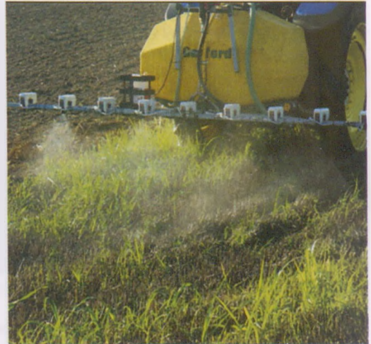
14. ábra. A tartókeretre felszerelt szórófejek
