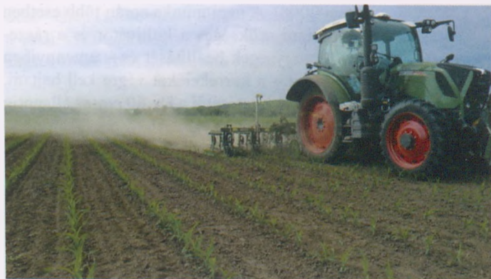
9. ábra. Szenzorvezérelt kultivátor + ujjasgyomirtó bio-kukoricában
