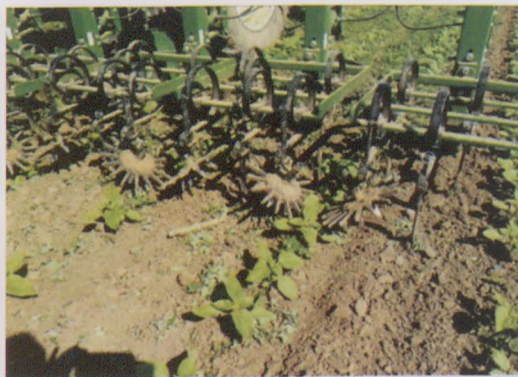
6. ábra. Az ujjas gyomirtók pozíciója a szenzorvezérelt kultivátoron. Fotó: Borsiczky István Fig. 6. Position of the finger weeder on the precision guided inter-row cultivator. Photo: István Borsiczky
