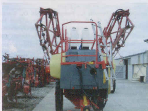
6. ábra. RAU permetezőre szerelt 2 db 70 literes adagoló tartály. (Fotó: Reisinger P.)
