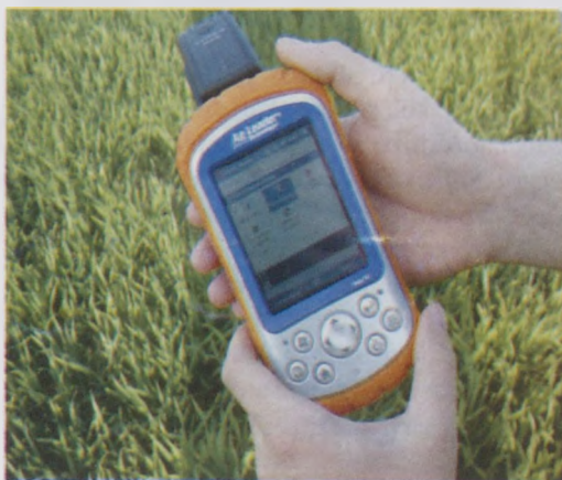
2. ábra. Helymeghatározó vevőkészülékkel kombinált terepi adatgyűjtő számítógép. Fotó: Reisinger Péter Fig. 2. Handheld field computer with positioning receiver. Photo: Peter Reisinger
