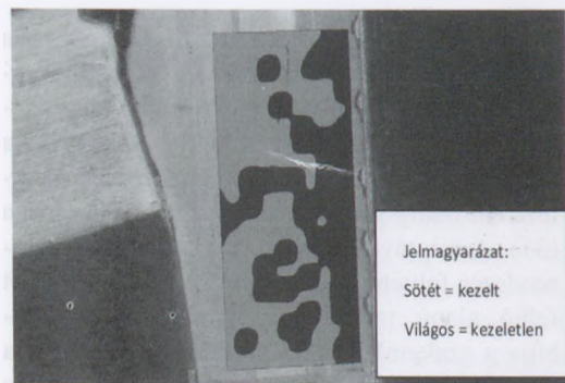
5. ábra. Helyspecifikus gyomszabályozási terv Fig. 5. The precision spraying map for site specific herbicide treatment (light: untreated, dark: treated)
