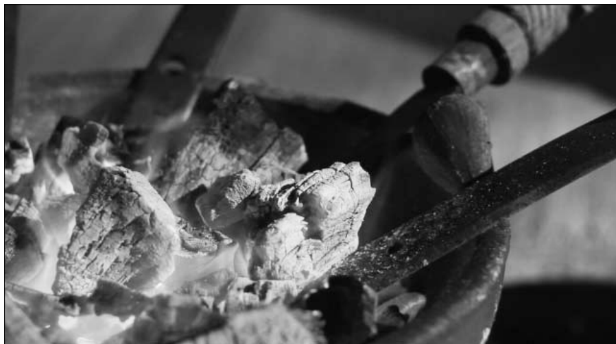
14. ábra. A vas szerszámok hevítése (videó részlet)
