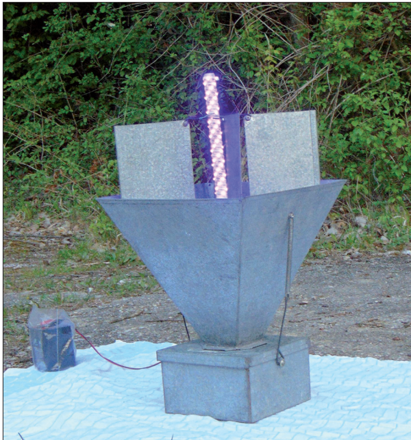
7. ábra: Hordozható fénycsapda 12 voltos UV LED-szalaggal felszerelve. – Fig. 8. Portable light trap fitted by a 12 V ultra-violet LED band.
