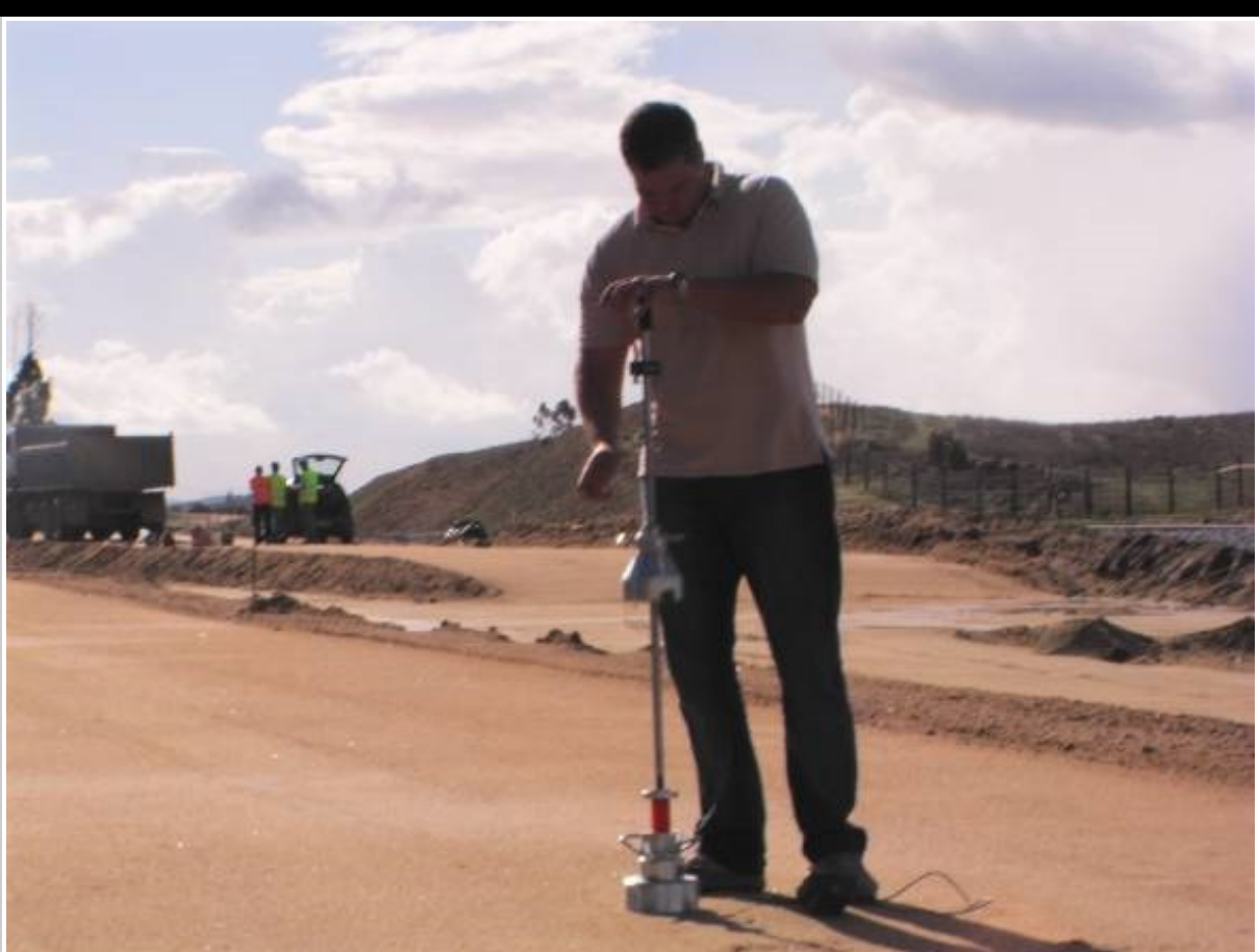
8. ábra ANDREAS új dinamikus tömörség- és teherbírás mérő műszere
