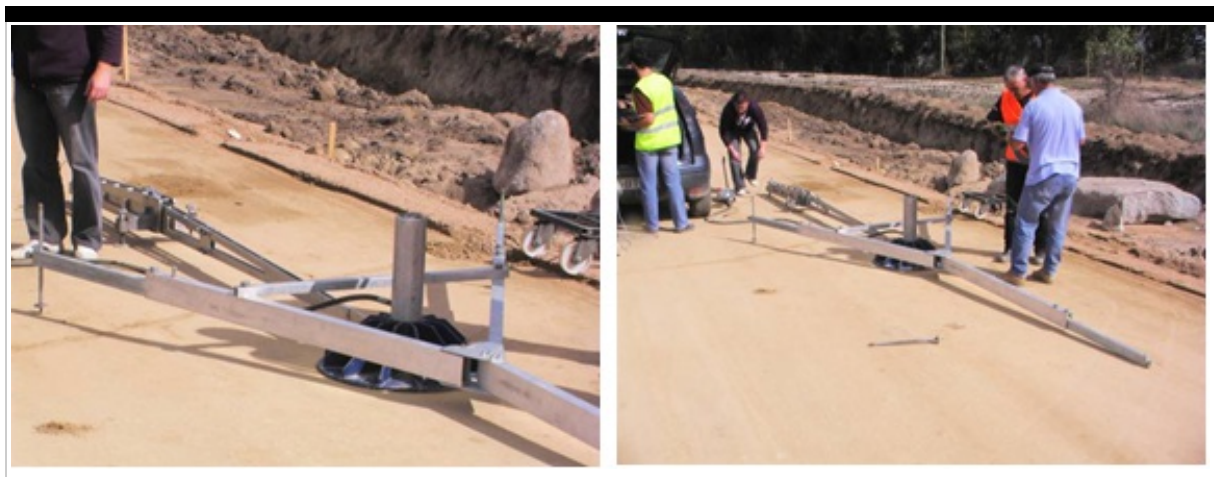
15. ábra Statikus teherbírás vizsgálat d=600 mm tárcsával
