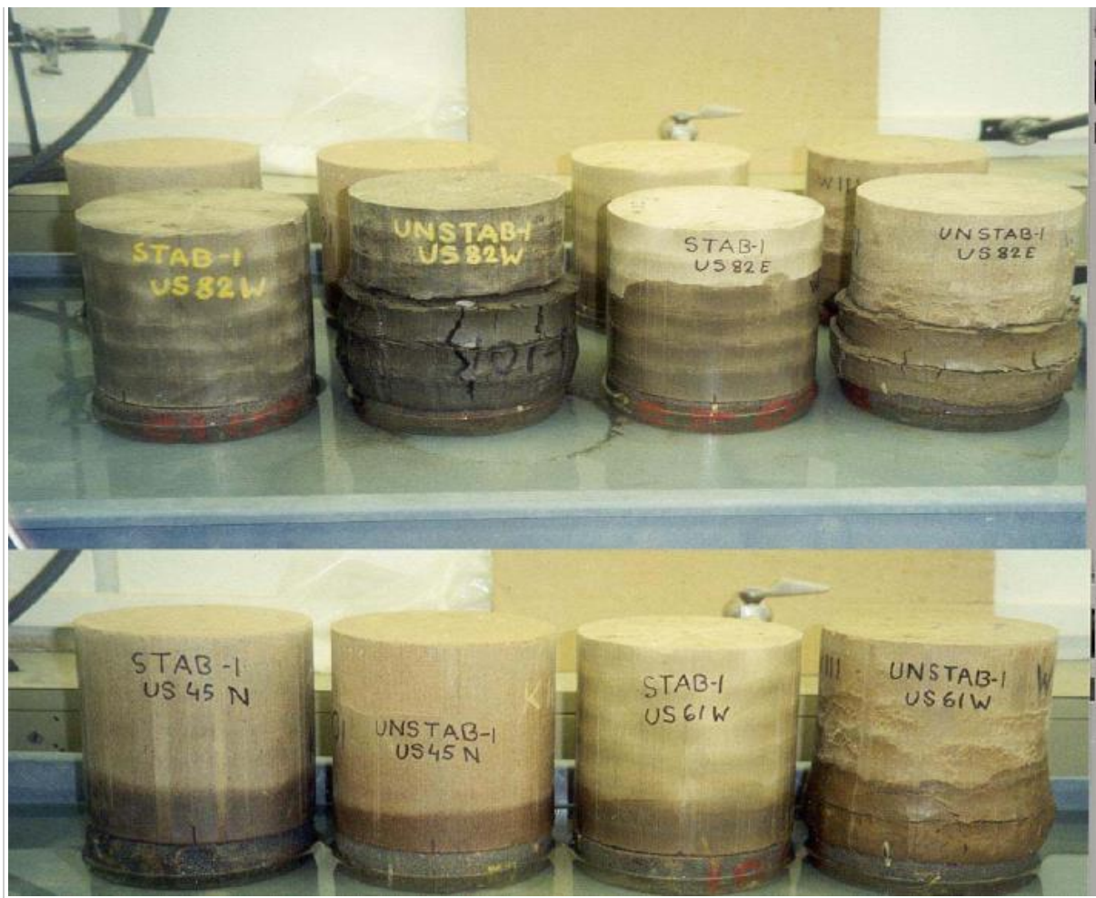
8. ábra Kapillaris vízfelszívás és tartóssági teszt az USA-ban I.
