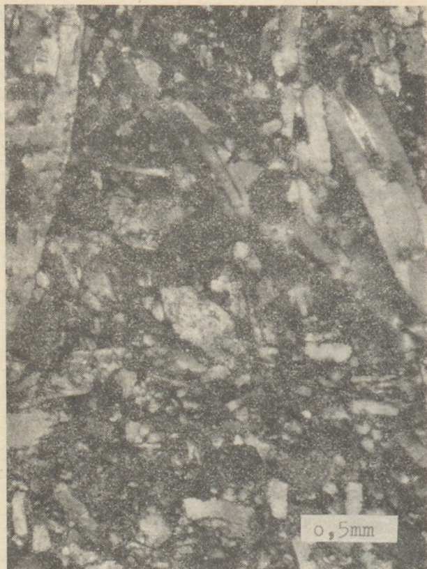
6. ábra. A nummuliteszes mészkő fénymikroszkópos képe
