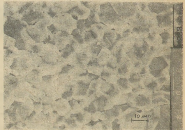
1. ábra. Az M-4 kísérleti szinter töretének SEM képe
