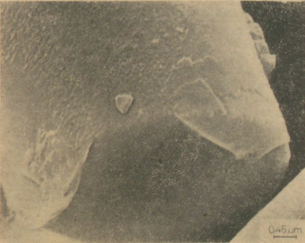
2. kép. Üvegszál 60 nap 70 °C-os folyamatos kezelés után
