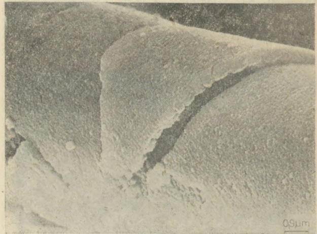
4–5. felvételek. Bazaltszál 60 h 105 °C-os kvázifolyamatos kezelés után
