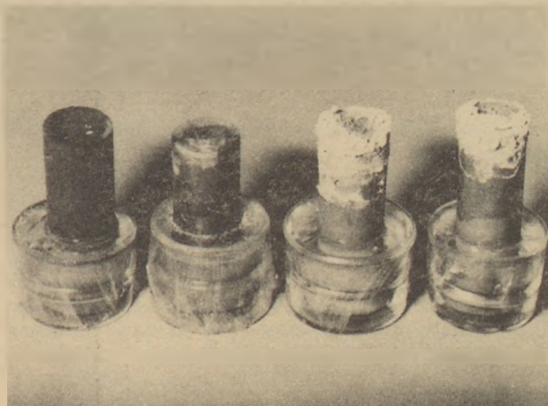
3. ábra. „K” agyagból készült próbatetek kivirágzása, növekvő gipszadagolás hatására
