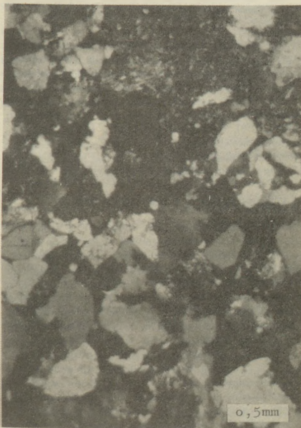
11. ábra. A schlaitdorfi, dolomitos kötésű homokkő fénymikroszkópos képe
