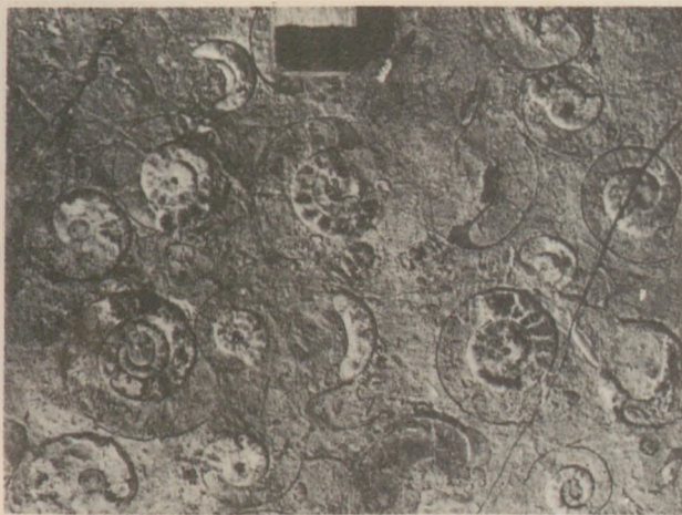
5. kép Bioklasztos mikrites mészkő (kalcilulit)
