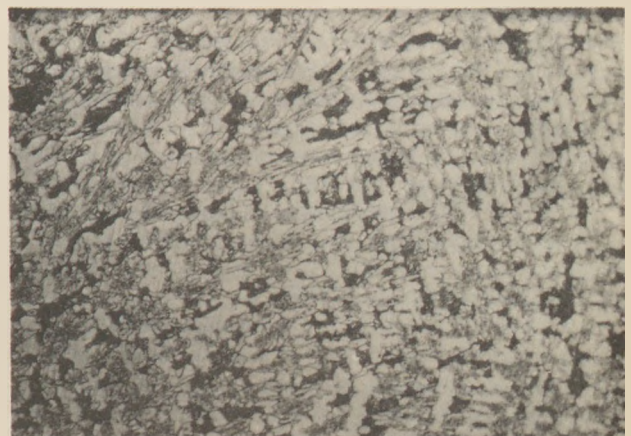
5. ábra. ÉLKEFÉM elektródával lerakott varrat szövetszerkezete (400 ×)
