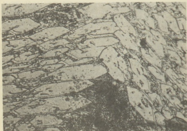
7 ábra. UTP 710 elektródával lerakott varrat szövetszerkezete
