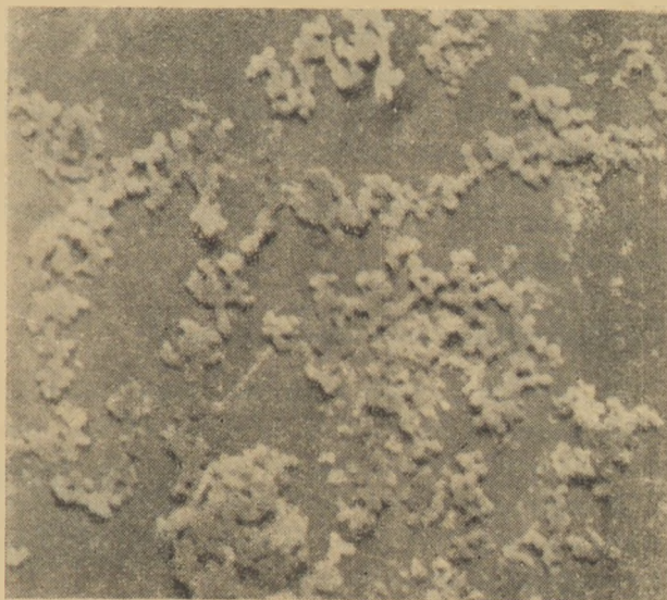
2. ábra. Közöséges körülmények között oltott mész — \text{Ca}(\text{OH})_2 kristályinak elektronmikroszkópi képe. Nagyítás: 600\times
