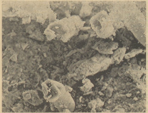
3. ábra. Polipropilén szálak elhelyezkedése azbesztcementben. Nagyítás: 440×
