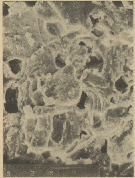
4. ábra. Szimultán szinter töret Felfűtés: levegőben, pO_2: 2,1 \cdot 10^4 Pa 1000 \times -es nagyítás .
