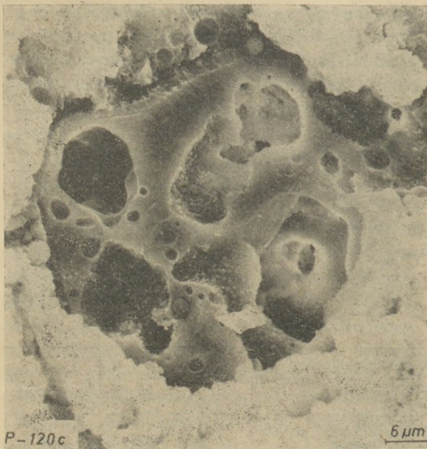
2. ábra. Hidratált pernye belső üregrendszer 2000×
