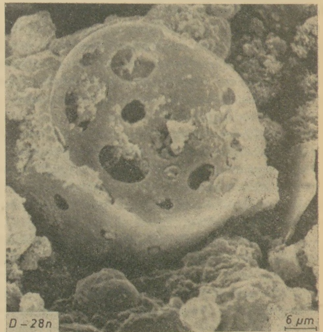
4. ábra. Hidratált pernye belső üregrendszer 2000×
