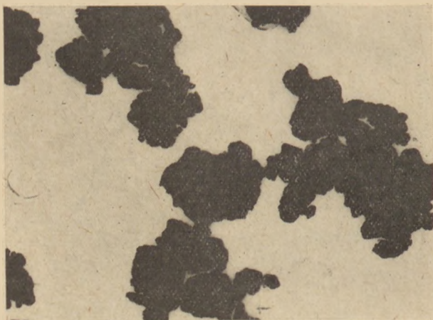
9. ábra. \beta C_2S őrlemény elektronmikroszkópi képe
