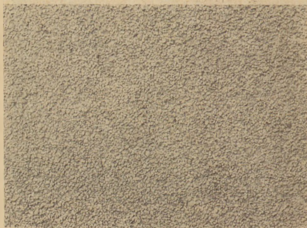
15. ábra. Melaszos kötőgátlóval jól készített házgyári panel felülete közelről fényképezve
