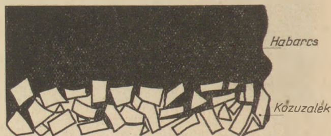
1. ábra. Homlokzati felület szerkezete kőzúzalék betérítése esetén
