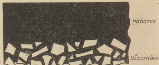
2. ábra. Homlokzati felület szerkezete felső kiképzés esetén
