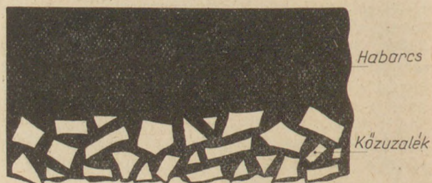
3. ábra. Homlokzati felület szerkezete kötőgátló alkalmazása esetén
