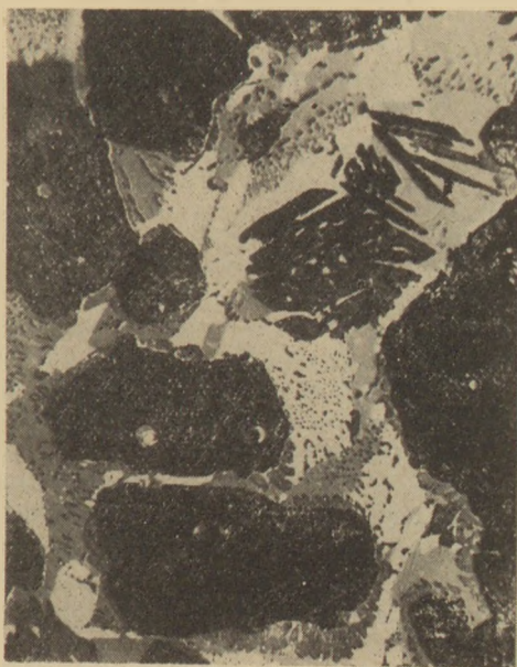
1. ábra. Cementklinker polírozott felületének mikroszkópi képe. Nagyítás: 540\times . A felvételt R. M. Grove készítette a Cement and Concrete Association-ban. A belső-kristálymagok túlalakúak, a kristály növekedése során zömökebb kristályok képződnek
