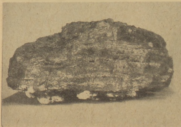
12. ábra. Folyékony állapotban Korvisit-lapról eltávolított rátapadt reve oldalnézetben
