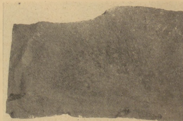
15. ábra. Cirkon-korund (4. táblázat 2. sz.) burkolólap makroszerkezete
