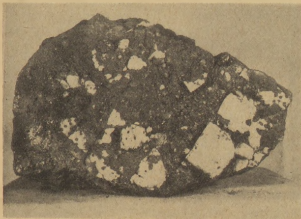
13. ábra. Folyékony állapotban Korvisit lapra tapadt reve által leszakított Korvisit darabok. A revének a lappal érintkező része
