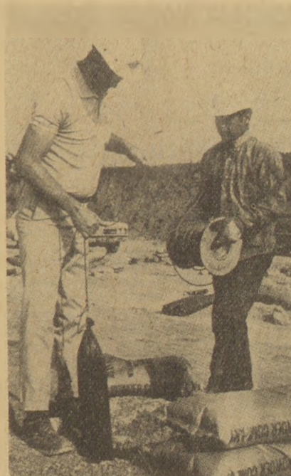
5. ábra. Zsákos zagyot engednek le a fúrólyukba, vitatható módon a robbanószinórra függesztve. (Austin—Powder felvétel)
