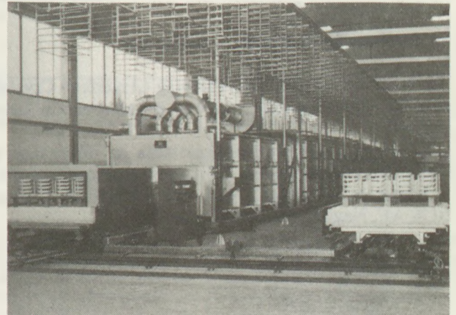
8. ábra Gyorségető alagútkeemence
