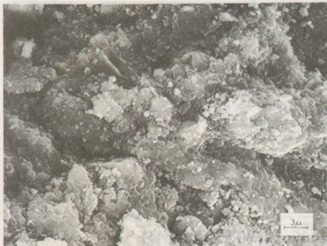
5. ábra Az őrlött hidrargillitből sajtolt próbatest SEM felvétele
