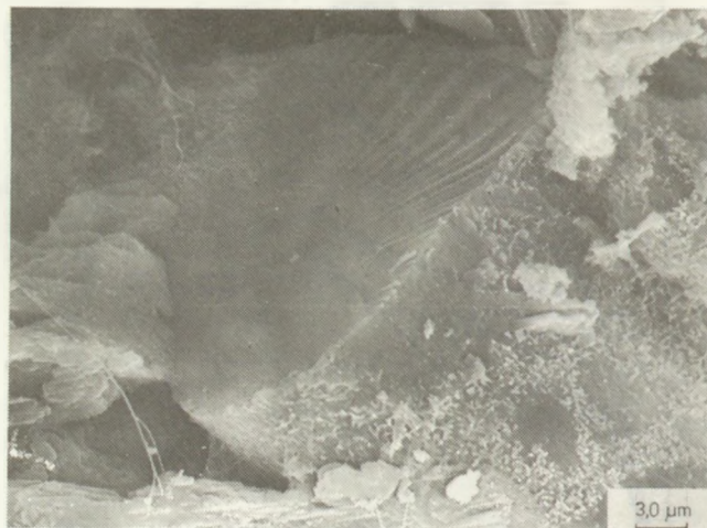
9. ábra Autoklávolt ac. lemezben lévő „Sibrál” szál
