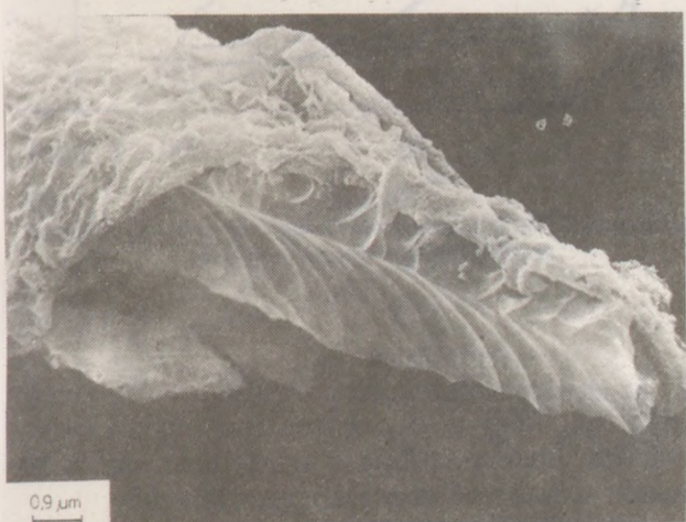
6. ábra „TEL” üvegyapot 70 °C-on 100 nap folyamatos telített mészvizes kezelés után
